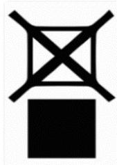
Le symbole ci-dessus indique que le système de stockage de cryoconservation ne doit pas être empilé. Empiler l'appareil pendant le transport, le stockage ou à tout moment par la suite annulera la garantie de l'appareil.
