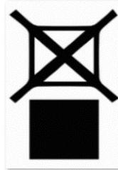
Il simbolo riportato sopra indica che il sistema di stoccaggio per crioconservazione non deve essere impilato. L'impilamento del dispositivo durante il trasporto, lo stoccaggio o qualsiasi momento successivo ne annullerà la garanzia.
