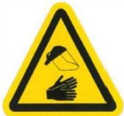
Este símbolo indica que é necessário equipamento de proteção pessoal para a utilização do produto. O agente de arrefecimento e armazenamento utilizado com este sistema de armazenamento de criopreservação é possivelmente perigoso. A Custom BioGenic Systems recomenda a utilização de uma proteção facial, óculos de segurança, luvas criogénicas e um avental criogénico.
